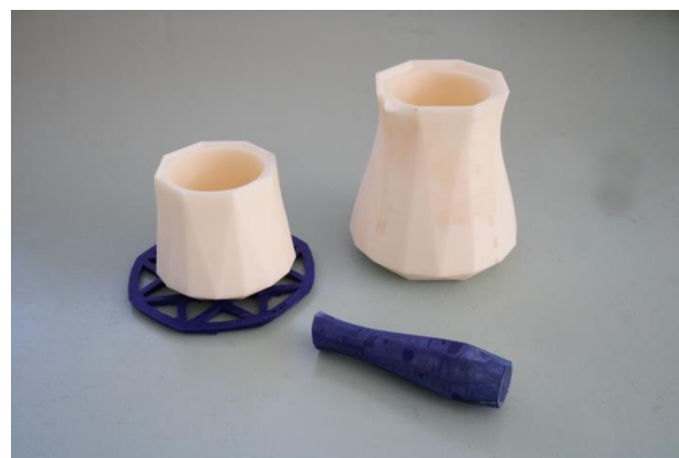
図3 3Dプリンタで出力した原型
