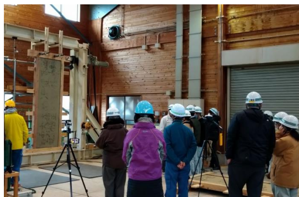
高校生対象の木材利用推進講座 (林業研究所において壁体の耐力試験実施)
