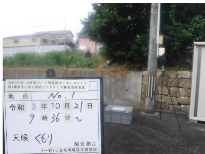
写真 4-7-3 供用後調査状況(地点No.1)(令和3年10月21日)
