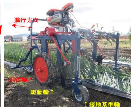
図2. マルチ剥ぎ同時掘り取り作業
