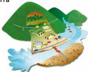
A camada de barro com facilidade de deslizamento sofre a ação da água subterrânea, e o solo solto começa a escorregar lentamente. Uma característica é que desliza extremamente devagar, e a área de terra empurrada é bem larga.
