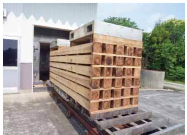
写真-1. 三重県産スギ柱材人工乾燥の様子
