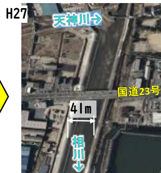
河口部から約900mの引堤完了 次のネック点は、新相川橋！
