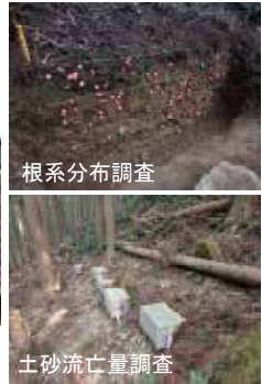
根引き抜き試験及び根系分布調査の実施、土砂流亡量の継続調査
