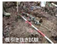
根引き抜き試験及び根系分布調査の実施、土砂流亡量の継続調査
