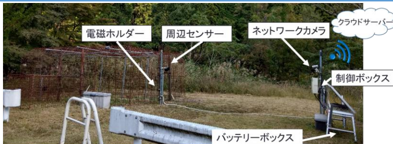
遠隔監視操作システムの概要
