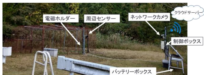
遠隔監視操作システムの概要
