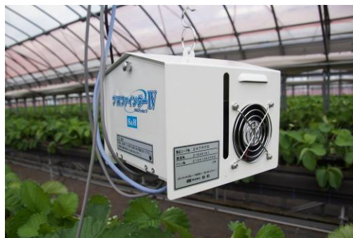
施設内環境を測定するセンサー
