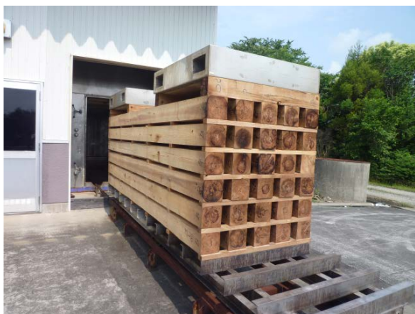
写真-1. 押角材による人工乾燥の様子
