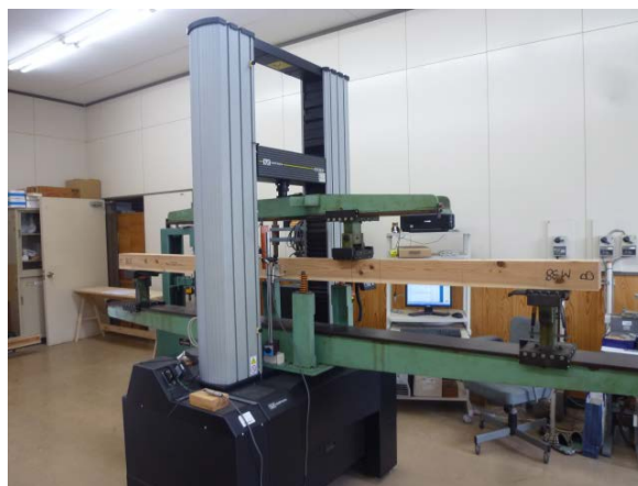
写真-2. 柱材曲げ強度試験の様子
