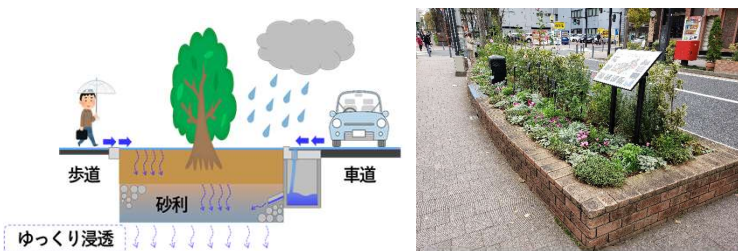
雨水浸透柵(横浜市)
