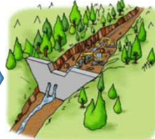
砂防堰堤堆積土砂撤去
