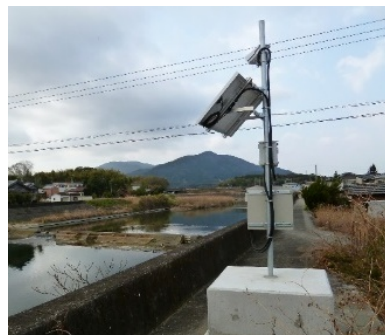
簡易型河川監視カメラ （三重県）
