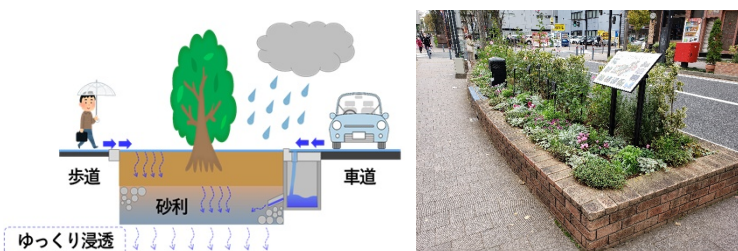
雨水浸透柵 (横浜市)
