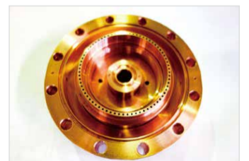
エンジンの気体燃料噴出部分に水谷精機工作所が製作した部品が使用されている。次に打ち上げるロケットにも使用される予定。（写真提供：JAXA、名古屋大学）
