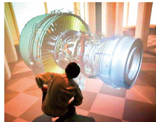
「プロジェクションVR」で機械の内部まで立体的に確認できる。
