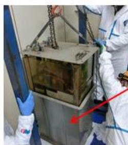
装置内は「絶縁油」で満たされている。この絶縁油に浸る内蔵の高濃度PCB使用コンデンサーの影響により、当該絶縁油にPCBが含有している可能性がある。
