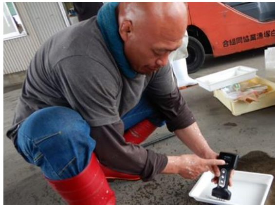
写真2 簡易測定器による脂質測定
