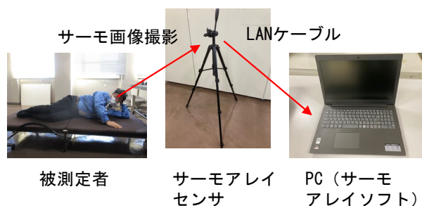
図1 サーモ画像撮影システム
