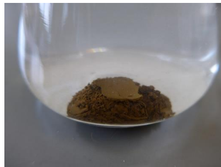
図5 未焼成ペレットを用いた溶出試験の様子 (ペレットの崩壊が確認できる)
