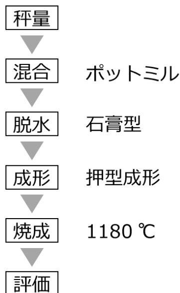
図1 耐熱陶器素地の試料作製手順
