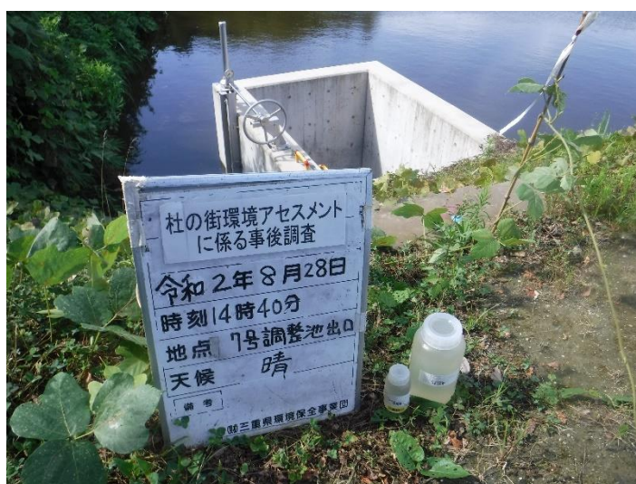
写真 2-1-8 濁水採水状況 (No.7) 令和2年8月28日
