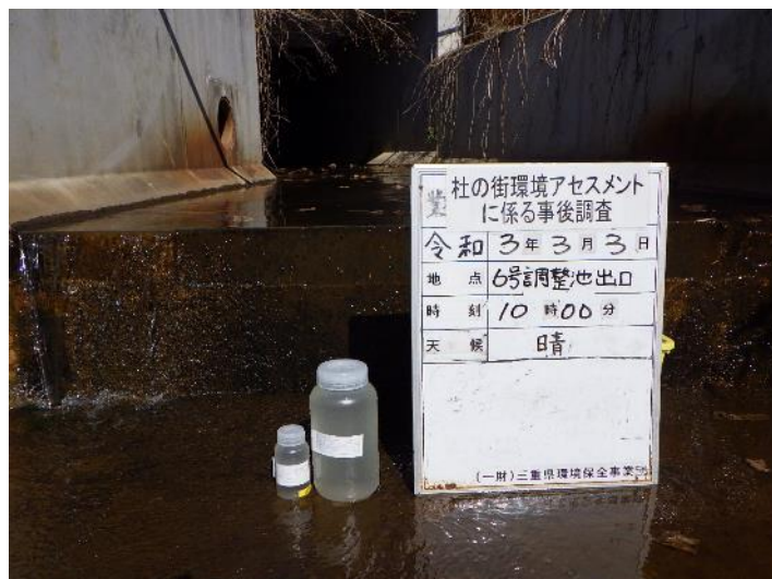
写真 2-1-27 濁水採水状況(No.6) 令和 3 年 3 月 3 日
