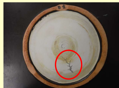
⑤IH土鍋の製品設計：IH発熱体の異常高温で発熱体が損傷
