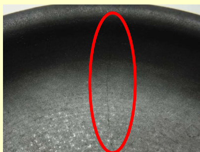
①耐熱陶土の開発：従来の直火用耐熱陶土では、IHの急加熱で割れる
