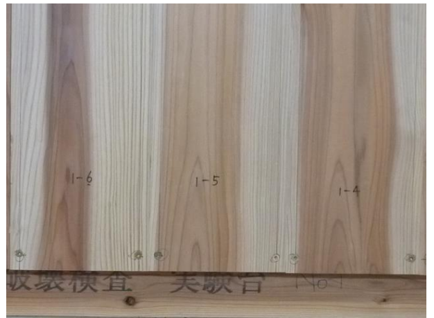
P90ビスでの桁への留め付け
