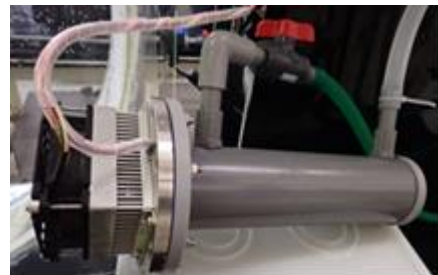
図 1. 深紫外 LED 海水殺菌装置
