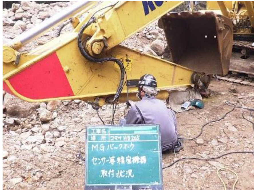
通常建機へのMG後 付けキット取付状況
