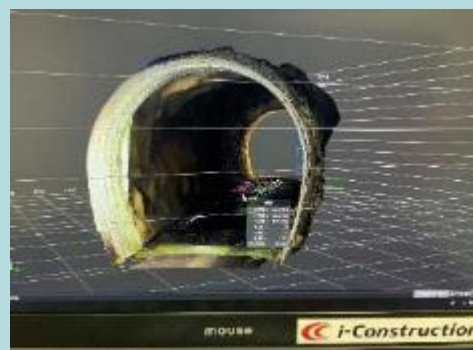
TLSによるトンネル断面の点群化
