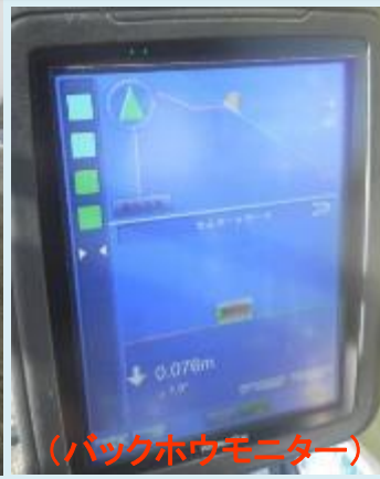
MCバックホウによる施工
