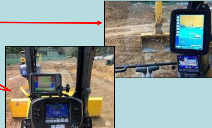
ICTバックホウ(0.8m 3 級)によるすき取りとICTブルドーザによる基面整正
