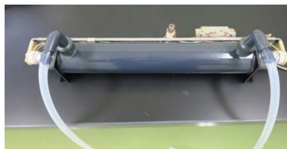
写真2 殺菌灯を取り付けた塩化ビニル製円筒管
