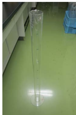
写真1 有機物の沈降速度試験に使用した亚克力パイプ
