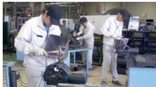
津高等技術学校での曲げ板金作業の様子
