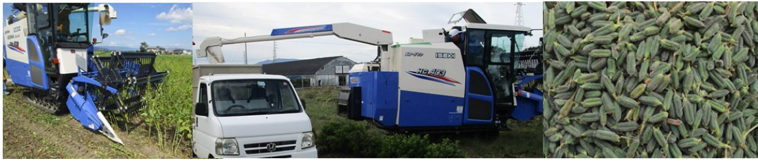
図1. 大豆コンバインでのゴマの蒴による収穫・排出作業 左:収穫作業、中央:排出作業、右:コンバイン収穫後、排出された蒴
