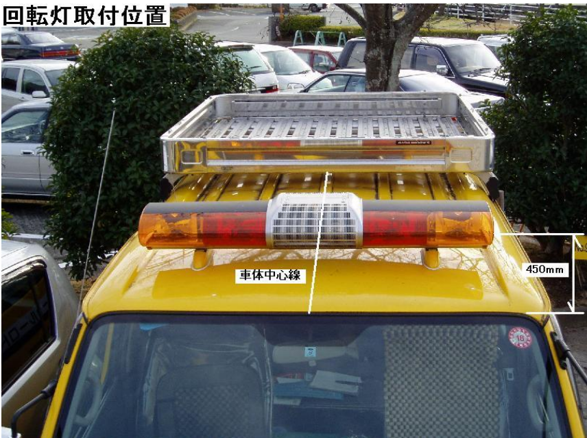
回転灯(前部) 全長:1130mm 取付:車体中心線上 前面から450mm
