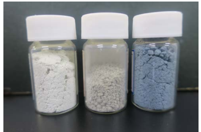
図1 クリソタイル(左)、アモサイト(中)、クロシドライト(右)
