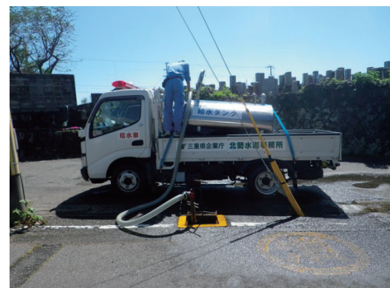
【給水車への補給作業(紀宝町)】
