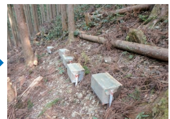
土砂受け箱を設置し、土砂流亡量を継続調査
