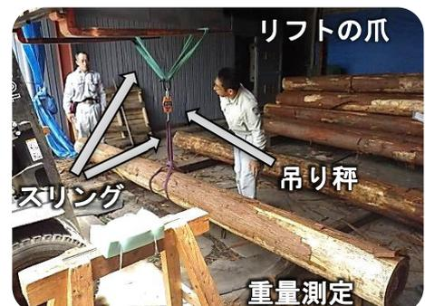
丸太を支持台またはフォークリフトの爪に載せ、木口をプラスチックハンマーで打撃した振動音を、反対の木口に当てた騒音計で拾い、FFTアナライザ（周波数分析器）を用いて共振周波数を測定
