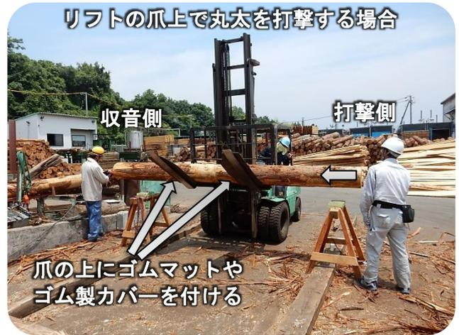
※ 打撃振動音が、丸太支持台と共振しないように、支持台と丸太の間にはスポンジ等の緩衝材を挟みます。
