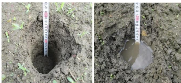
図1-(2)-2. 浅層穴内の滞水状況
