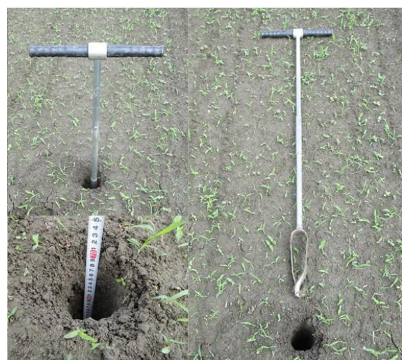
図 3-1-3. 地下水位の測定
