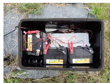
図 4-(2)-7. UV-LED トラップのコントロールおよび電源ボックスの内容
