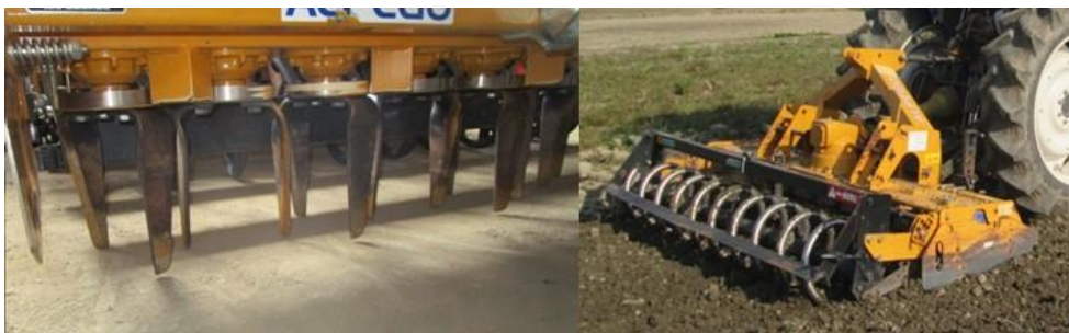
図 2-(1)-6. 縦軸駆動ハローの一例
