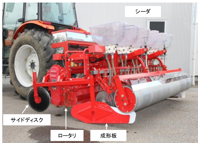
図 2-(1)-7. 小明渠浅耕播種機の一例
