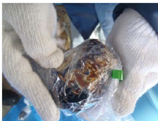
油状の液体が多量に付着した剥き身コンデンサ
