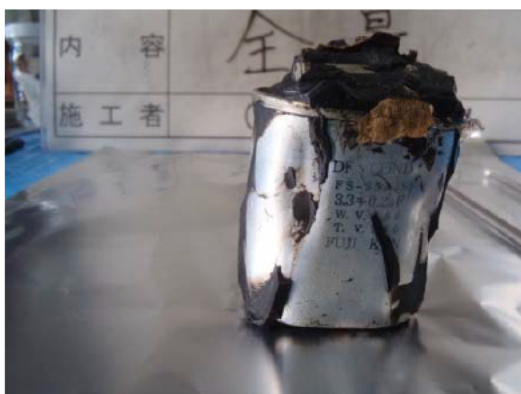
変形した剥き身コンデンサ (1)
