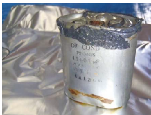
補修した剥き身コンデンサ (2)
