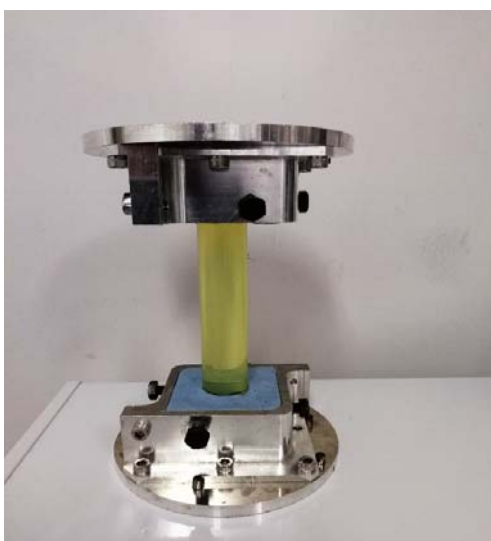
図4 ウレタンゴムに治具を取り付けた状態
