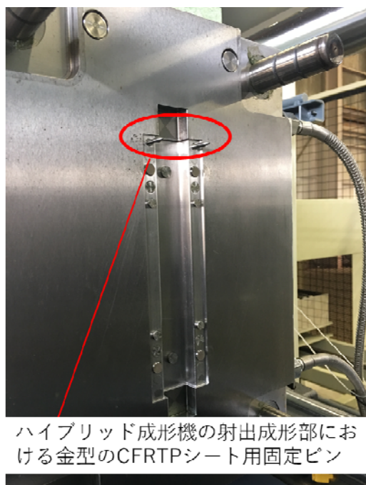
図 3 ハイブリッド成形機の射出成形部における金型の CFRTP シート用固定ピン
