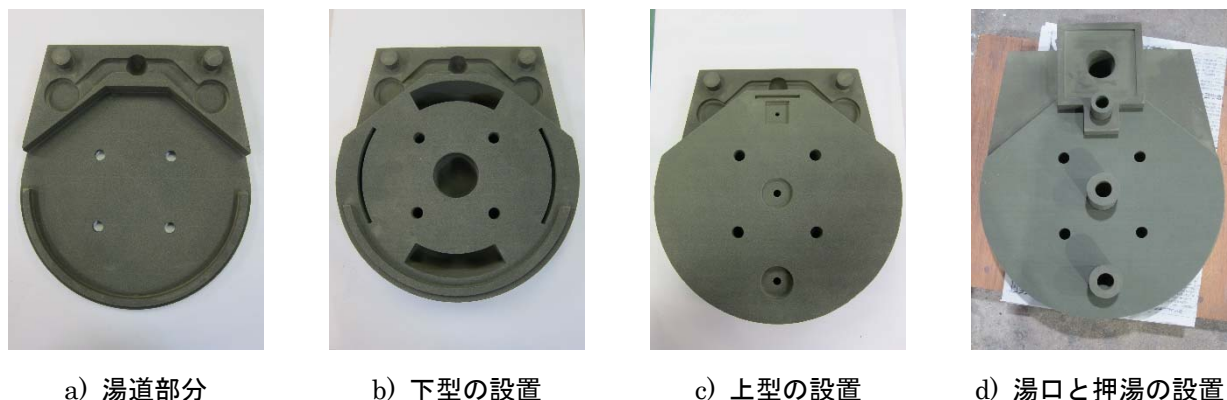
図7 パーツ化砂型の組付け例 (方案#4)
