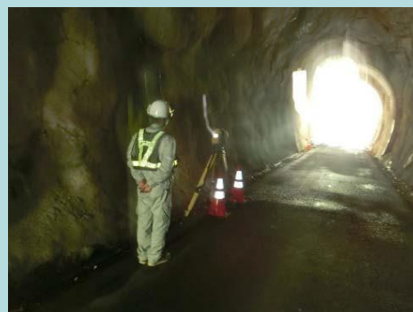
TLSによる測定状況
