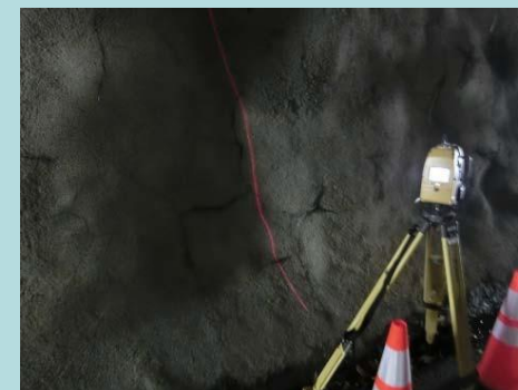
TLSによる測定状況
