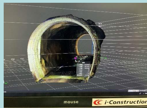
TLSによるトンネル断面の点群化
