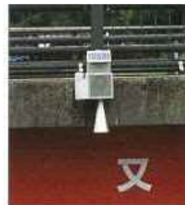
橋梁に設置するタイプ (電波や超音波で河川 に触れずに計測)
