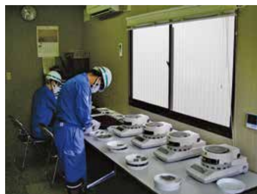
RDF受入検査
