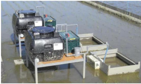
図1 水位調節枠装置ほ場設置写真
