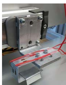
図 3 コの字形起歪体 (実物写真)
