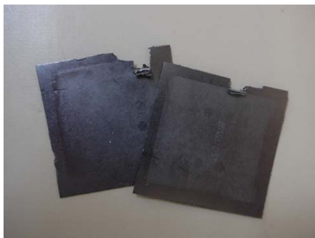
図 9 劣化したグラファイトシートの外観 (上部の損傷は、ユニットから剥離した際に付いたもの)
