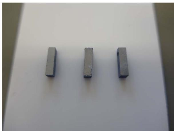
図3 研磨後の焼結体（左）および切削後の素子（右）
