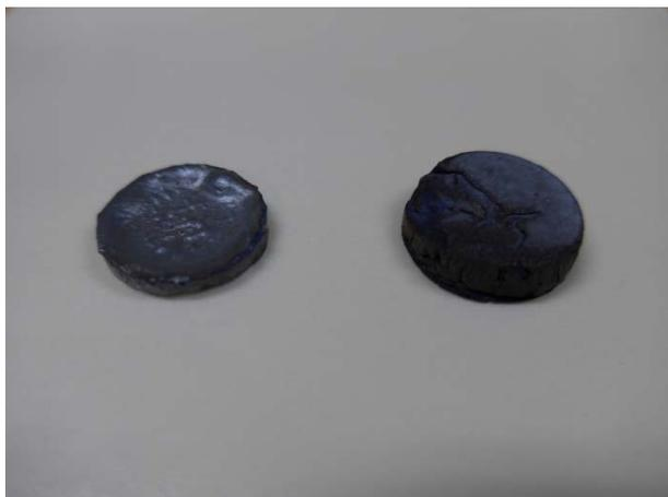
図1 密封炉内で冷却し，得られた焼結体の例
