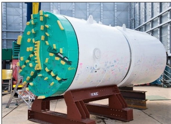
φ 1200 配水管工事（シールド掘進機）
