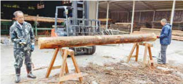
写真-1. 打撃音法による縦振動ヤング率の測定
