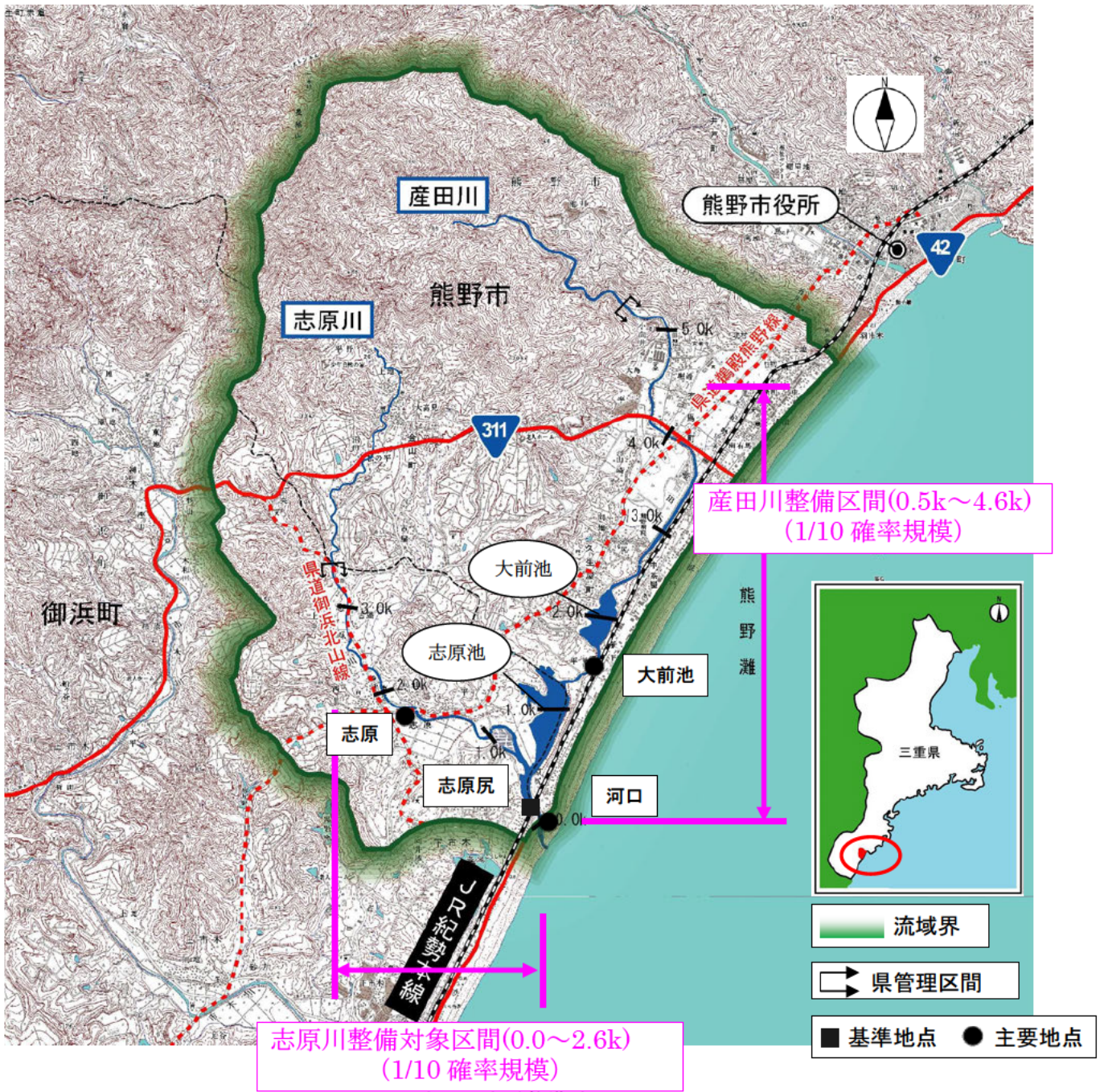
図一4.8 志原川水系整備計画平面図
